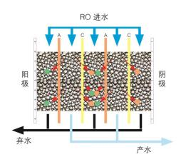
EDI 对水中离子的去除基于三个过程-电渗析过程,离子交换过程和树脂的电化学再生过程。相比一般的离子交换,EDI 通过电场,可以让活跃的锂离子快速定向迁移,通过弃水排放,锂离子与交换树脂之间吸附与解离之间的平衡被破坏,因此被高效去除,给用户满意的纯化效果。
