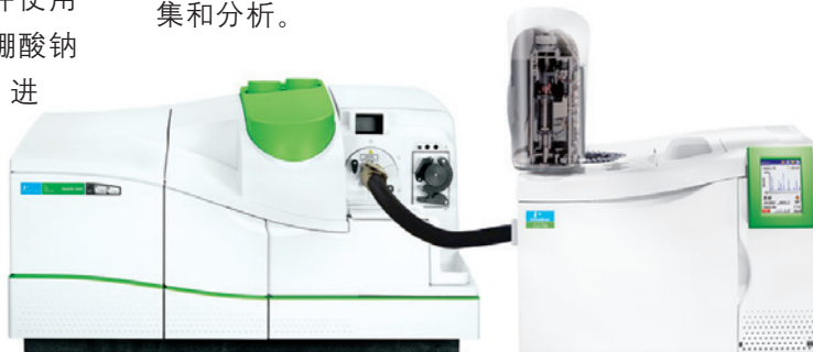
图1. 通过GC传输线联接Clarus 580 GC (右) 和 NexION 300D ICP-MS (左)
